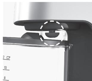
**6. Ако свалите каната,** клапата на филтъра предотвратява изтичането на кафе върху затоплящата плоча. **Докато ври, каната не трябва да бъде свалена за повече от 30 секунди, в противен случай филтърът ще се препълни.**
