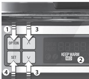
**2. Регулиране на температурата за поддържане на топлина (само за кафе машини със стъклена кана):** Натиснете бутона Option . Изберете желаната температура (висока/средна/ниска), като натиснете бутона (▲) или (▼). Натиснете бутона Set за потвърждение.
