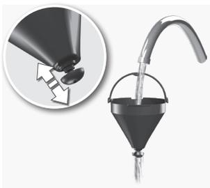
**5. Faire au minimum deux rinçages complets de la cafetière.** Rincez ensuite abondamment la verseuse, le couvercle et le porte-filtre à l'eau courante en activant le système anti-gouttes de celui-ci à plusieurs reprises.
