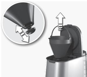
2. **Pour nettoyer le porte-filtre,** soulevez la poignée et retirez le porte-filtre. Pour bien nettoyer le clapet du filtre, appuyez plusieurs fois dessus lorsque vous le rincez. Le porte-filtre et le filtre à café permanent peuvent également être lavés au lave-vaisselle.
