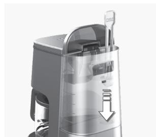
**6. Paigutage PureAdvantage™ filter** (filtrioits allpool) veemahuti põhjas olevasse vastavasse taskusse.
