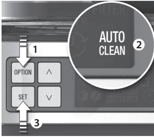
**4. Kahveliği kapağıyla birlikte** ısıtma plakasının üzerine yerleştirin. Kireç çözücünün etkisini göstermesi için yaklaşık 15 dakika bekleyin. Option tuşuna iki kez basın. Ekranda "Auto Clean" (Otomatik Temizleme) yazısı görünür. Set tuşuna basarak onaylayın. İşlem bittiğinde su akışı durur ve üç bip sesi duyulur. Gerekirse kireç çözme işlemini tekrarlayın.
