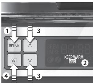
**2. Nastavenie teploty zohrievania (len pre model kávovaru so sklenenou nádobou):** Stlačte tlačidlo Option. Zvoľte požadovanú teplotu (vysoká/stredná/nízka) stláčaním tlačidla (▲) alebo (▼). Voľbu potvrdíte stlačením tlačidla Set.
