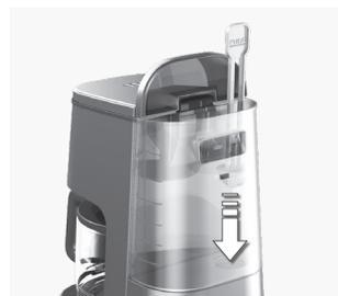
**6. Поставете филтъра за PureAdvantage™ (с края на филтъра напред)** в торбичката на дъното на водния резервоар.
