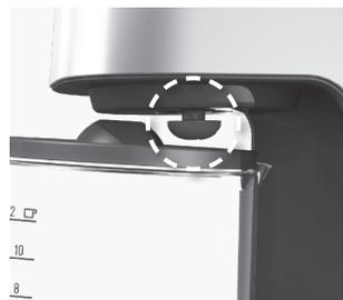
**6. Lorsque la verseuse est retirée,** le système anti-gouttes empêche le café de goutter sur la plaque chauffante. **Pendant le passage du café, ne pas retirer la verseuse pendant plus de 30 secondes, le filtre risquerait de déborder.**
