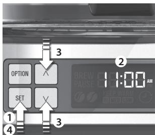
**1. Nastavenie hodín:** Stlačte a podržte tlačidlo Set, kým čas (hodiny) na displeji nezačne blikať. Stláčaním tlačidla na posun nahor (▲) alebo nadol (▼) zmeníte hodinu a potom voľbu potvrdíte stlačením tlačidla Set. Nastavte minúty (a nastavenie AM – dopoludnia alebo FM – popoludní) pomocou tlačidla (▲) alebo (▼) a voľbu potvrdíte stlačením tlačidla Set.
