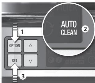
**4. Nádobu na kávu s vekom umiestnite** na ohrievaciu platňu. Nechajte odstraňovač vodného kameňa pôsobiť približne 15 minút. Dvakrát stlačte tlačidlo Option. Na displeji sa zobrazí správa „Auto Clean“ (Automatické čistenie). Voľbu potvrdíte stlačením tlačidla Set. Po dokončení čistenia voda prestane vytekať a zaznejú tri pípnutia. Proces odstraňovania vodného kameňa podľa potreby zopakujte.
