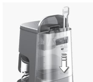
**6. Placez le filtre PureAdvantage™** (extrémité du filtre d'abord) dans l'emplacement prévu à cet effet.
