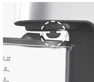
**6. Ak sa nádoba na kávu vyberie,** ventil filtra zabráni kvapkaniu kávy na ohrievaciu platňu. **Počas varenia sa nádoba na kávu nesmie vybrať na viac ako 30 sekúnd. V opačnom prípade filter pretečie.**
